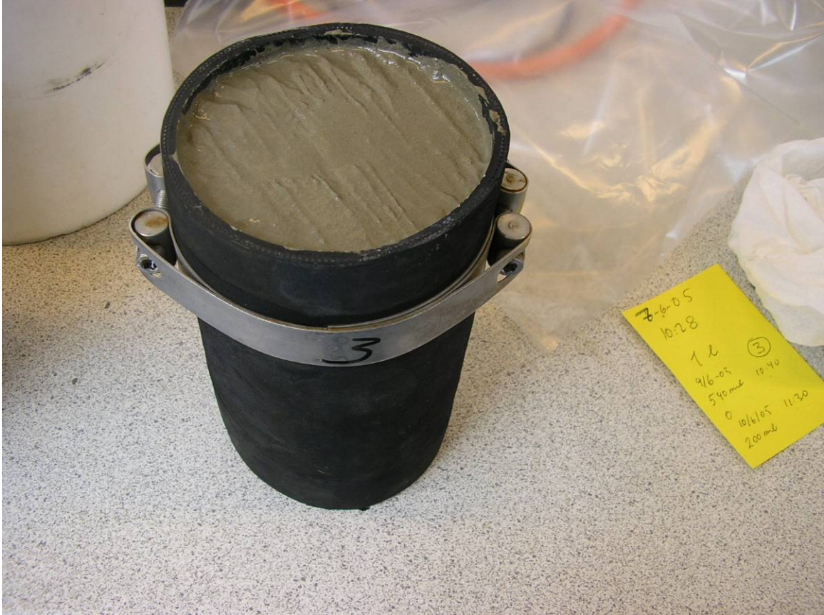
Mynd 19. Sýni 3 með um 3 mm þykku lagi af XYPEX (down-stream)
