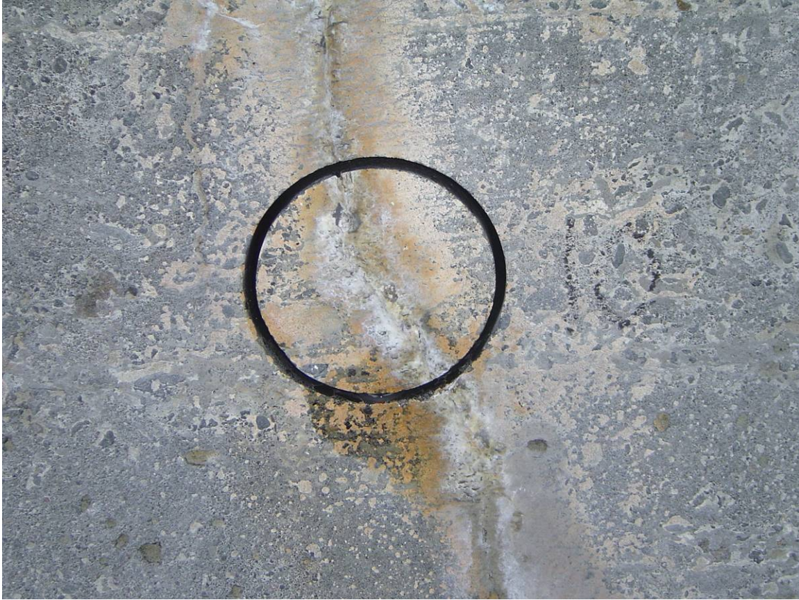
Mynd 3. Borkjarni 9 (og einnig kjarni 10) voru boraðir á sprungu.
