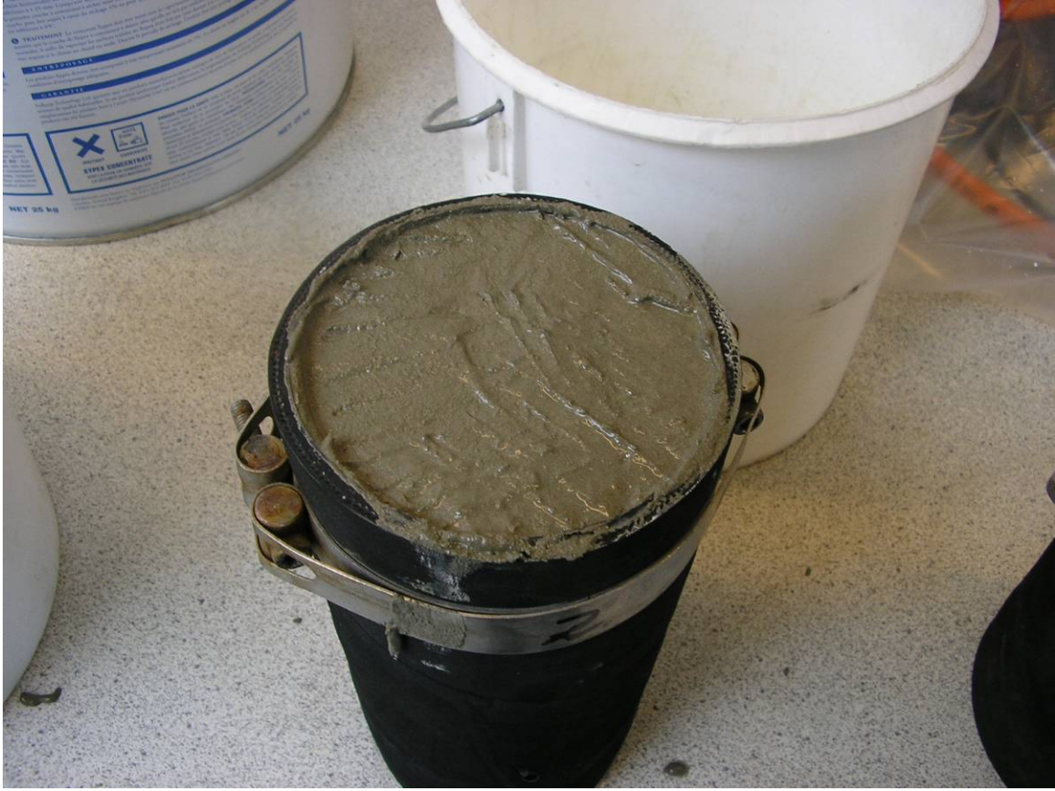
Mynd 18. Sýni 2 með um 3 mm þykku lagi af XYPEX (down-stream)
