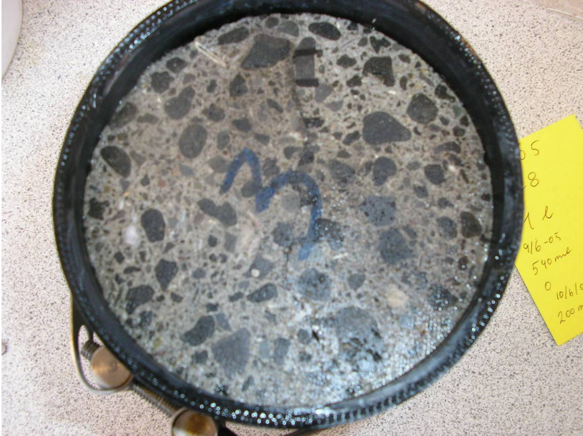
Mynd 17. Sýni 3. Töluverður leki var í sýninu. Sprungan liggur upp-niður eftir miðju sýninu.
