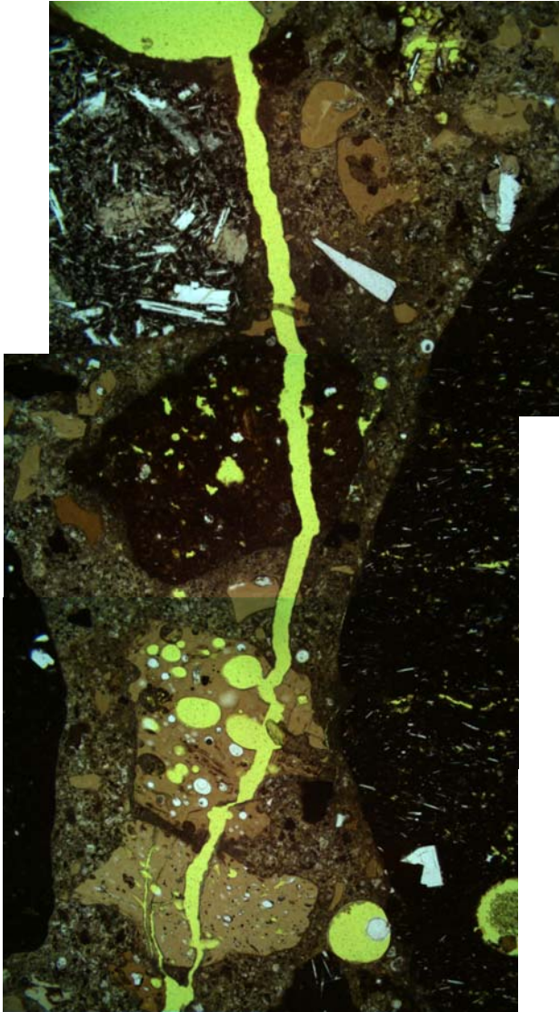
Mynd 11. Smásjármynd af yfirborðsprungu í kjarnar 9.
