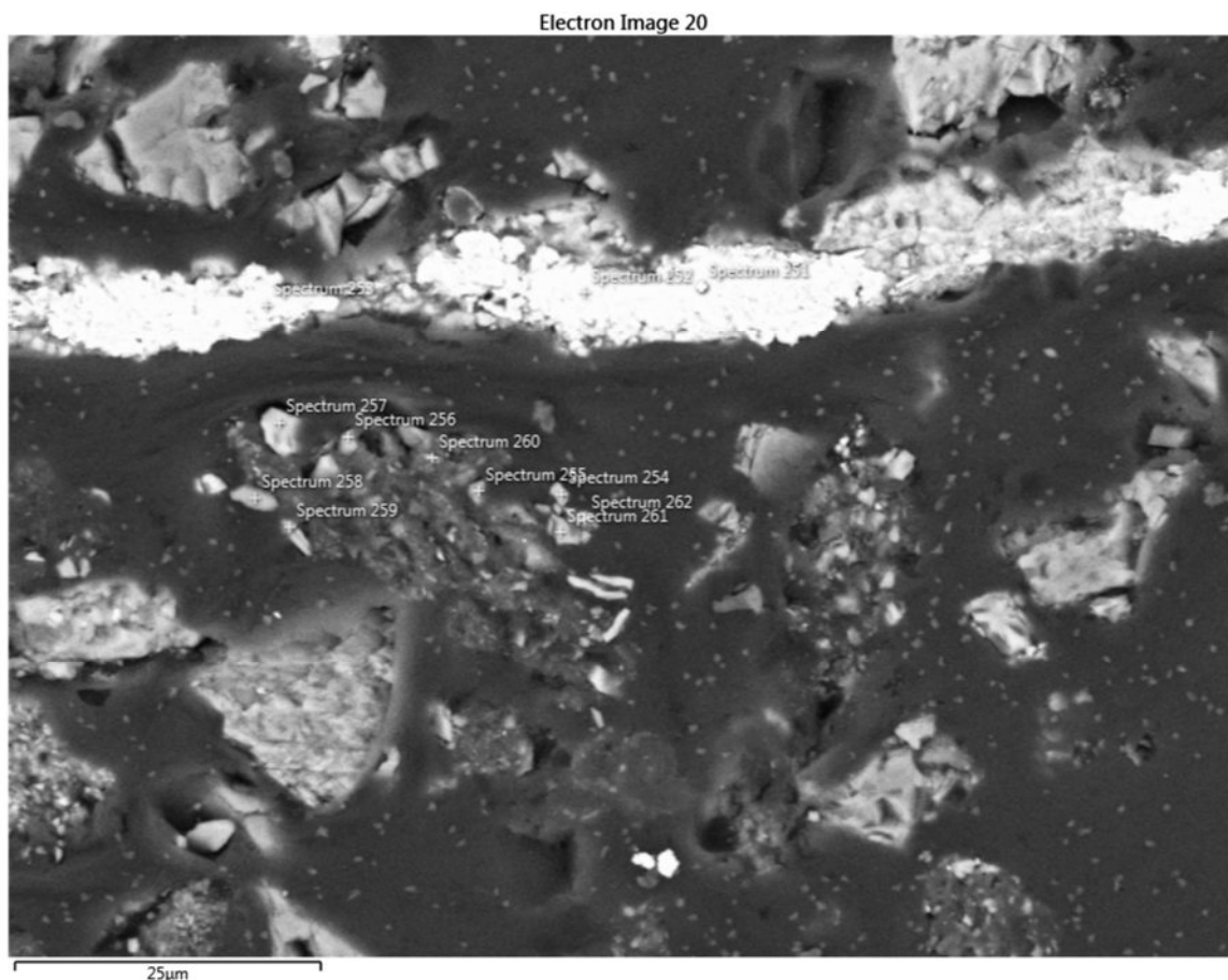
Mynd 37. Rafeindasmásjármynd af ryksýni úr stöð 4603 teknu 13.06.18, svæði 12. Á myndinni má sjá staðsetningu á efnagreiningum 251 til 262. Krossar sýna staðsetningu á punktgreiningum. Lengdarkvarði í vinstra horni niðri.
