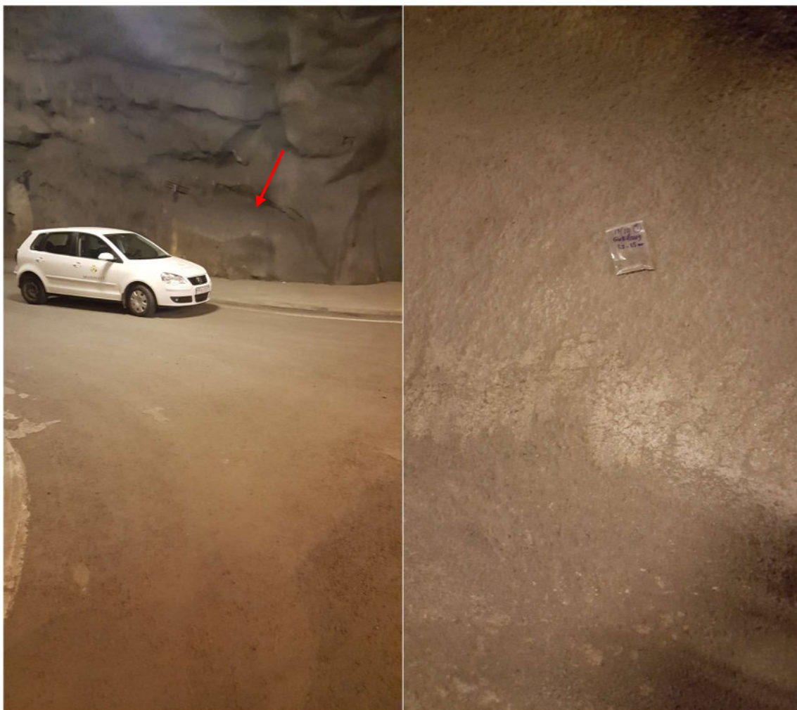
Mynd 2. Stöð 5100 (Guðlaug). Sýnum var safnað af sprautusteypunni í um 1,2 til 1,5 m hæð. Örin bendir á svæðið þar sem sýnin voru tekin.
