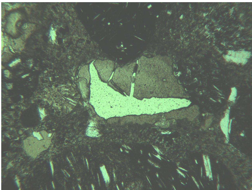
Mynd 8. Ljóssmásjármynd af steypu úr stöpli 11. Dæmi um hlaupsmyndun á um 24 mm dýpi. Myndin þekur 1,04 x 1,36 mm.
