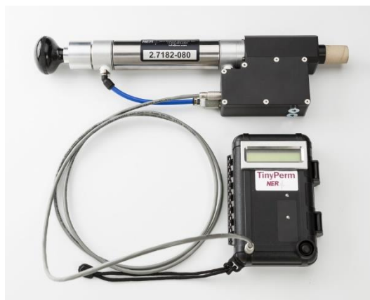
Mynd 2. Tiny Perm mælir sem notaður var til lektarmælinga.
