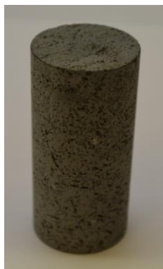
Mynd 1. Basaltsýni tilbúið til prófunar
