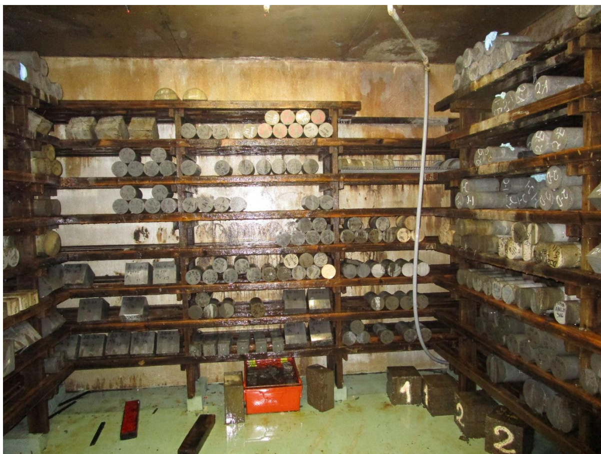
Mynd 6: Rakaklefi þar sem sementsefju-, múr-, og steypustrendingar eru geymdir við u.þ.b. 100% rakastig á Nýsköpunarmiðstöð Íslands fyrir brotþolsprófanir.
