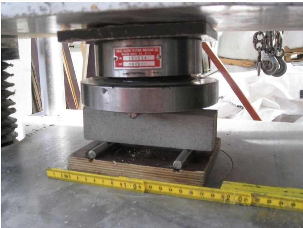
Mynd 5: Beygjutogþolsmæling í Tinius Olsen brotþolsmælitæki þar sem hver strendingur er brotinn í tvo hluta við mælingu á beygjutogþoli og svo eru báðir hlutarnir notaðir til að mæla þrýstipól.
