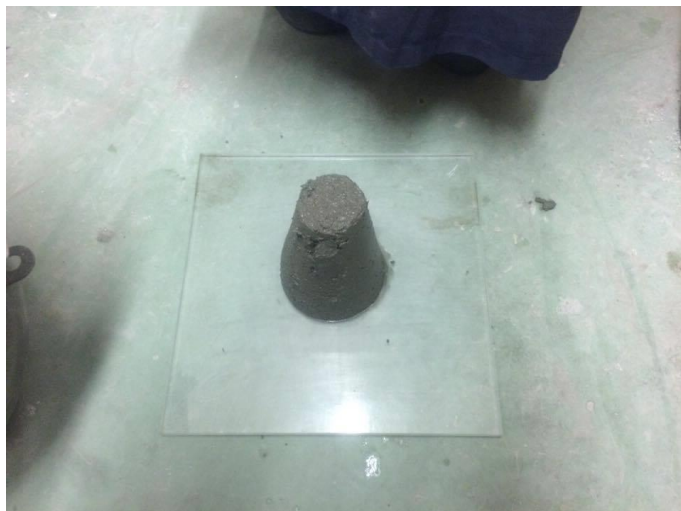
Mynd 19: Flæðieiginleikar sementsblöndu með w/c = 0,55 og 1,25% koltrefjainnihald. Þvermál sýnisins mældist 10 cm.
