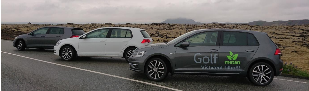
MYND 4 Volkswagen Golf bifreiðar frá Heklu notaðar við hljóðmælingar, knúnar þremur mismunandi aflgjöfum. Mynd frá vettvangi mælinga.
