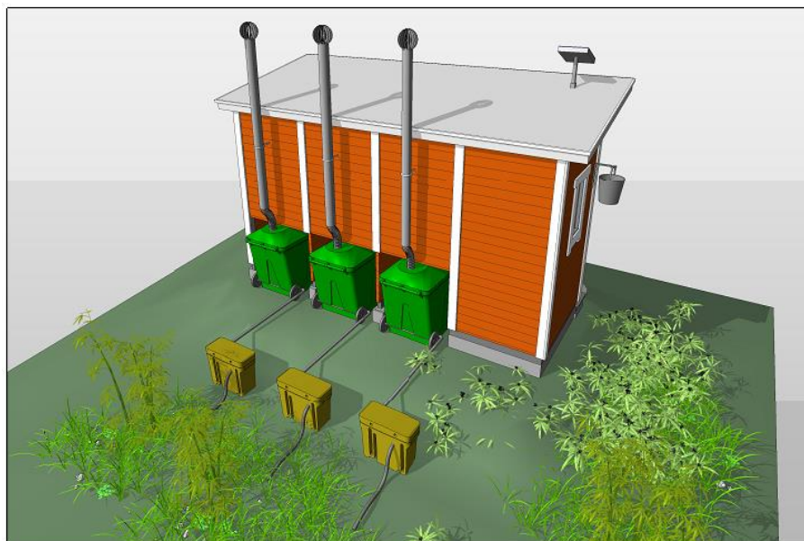
MYND 6 Dæmi um þurrsalernisbyggingu þar sem notast er við þurrsalerni af gerðinni Green Toilet 330. Þvag er aðskilið frá fastefni og safnað í minni tanka þar sem síun fer fram áður en þvagið er leitt í jörðu. Mynd er fengin frá Pikku Vihreä í Finnlandi.
