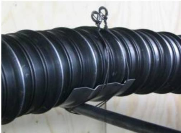
Abb. II.11: Schutzschalen aus Stahl und Drahtbinder sind bei Spanngliedkategorie b und c nicht gestattet.
