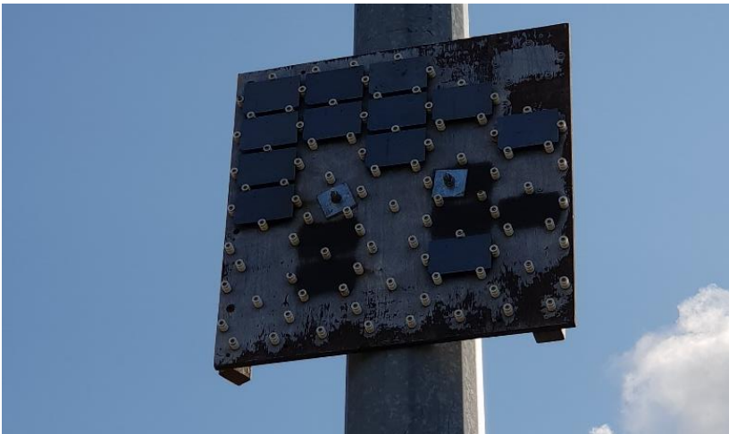
MYND 3 Tæringarreki með 12 sýnum á Rarik lóðinni á Egilsstöðum.
