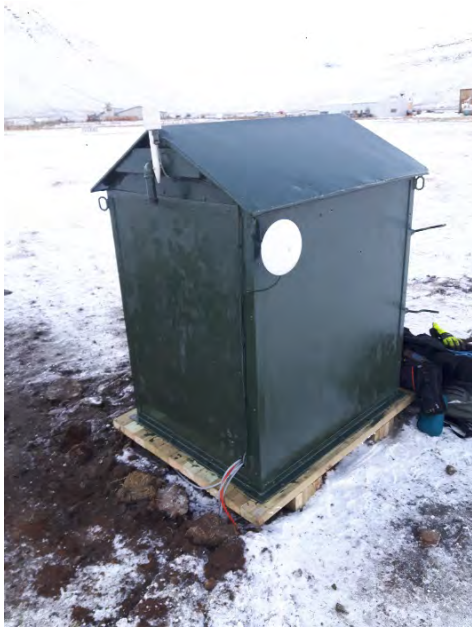
Mynd 2. Kofi sem hýsir miðju-stöðina. Gögnin fara yfir radiótengingu úr disknum á kofanum að skrifstofu Snjóflóðaseturs.
