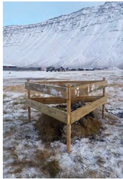
Mynd 3. Innhljóðsnemi grafinn í tunnu, með blómapotti yfir og fyllt upp að með jarðvegi. Girðingin er til að auka sýnileika.
