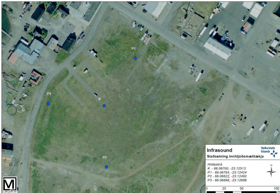
Mynd 1. Staðsetning innhljóðsmæla á Suðurtanga. Miðjustöðin er merkt með K og þar er einnig einn nemi. Aðrir nemar eru merktir P1-P3.
