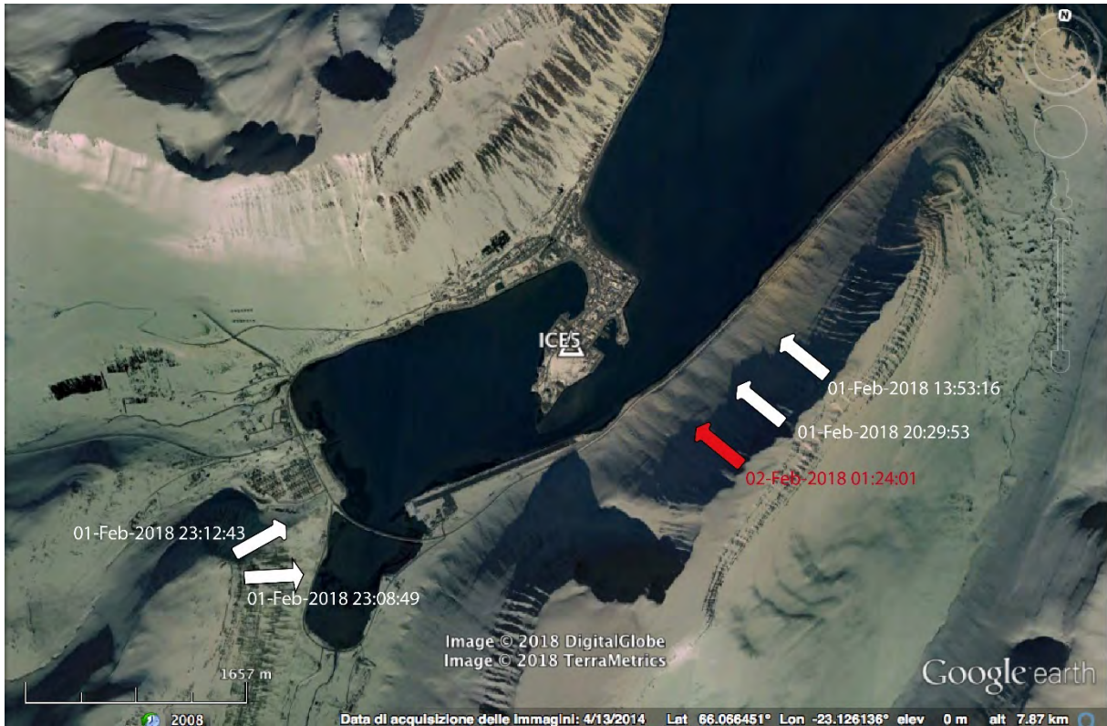
Mynd 14. Sjálfvirkar greiningar á atburðum 1.–2. febrúar. Rauða örin sýnir atburð þar sem áreiðanleiki er metinn mikill, en hvítu örvarnar atburði þar sem áreiðanleikinn er lítill. Það féllu mörg snjóflóð á Kirkjubólshlíð að kvöldi 1. eða aðfaranótt 2. febrúar. Mynd frá Unifit.
