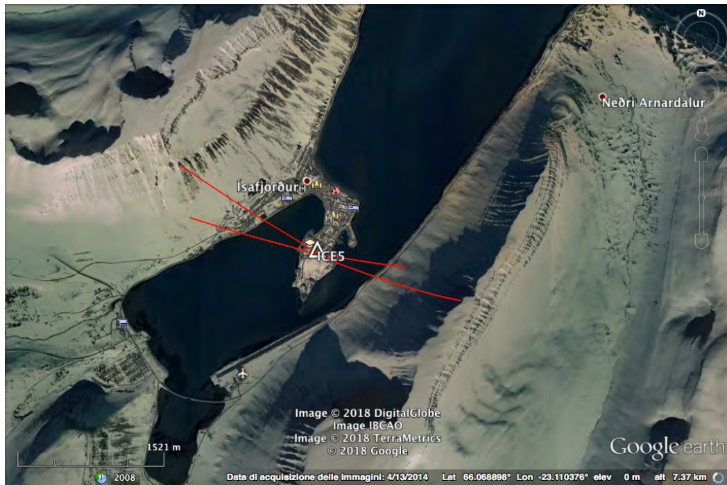
Mynd 13. Sjálfvirk greining atburða með drunumælum 17. janúar 2018. Bæði flóðin voru staðfest um morguninn, en þau féllu kl. 3:35 og 3:42 um nóttina. Mynd frá Unifit.
