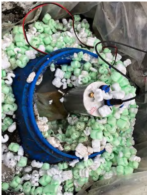
Mynd 16. Vatn komst inn í tunnuna sem geymir skynjarann sem varð til þess að skynjarinn flaut upp og einnig frauðplastið sem var í tunnunni. Þrýstingurinn varð til þess að lokið fór af tunnunni. Það sást þegar blómapotturinn var tekinn af.
