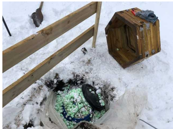
Mynd 16. Vatn komst inn í tunnuna sem geymir skynjarann sem varð til þess að skynjarinn flaut upp og einnig frauðplastið sem var í tunnunni. Þrýstingurinn varð til þess að lokið fór af tunnunni. Það sást þegar blómapotturinn var tekinn af.
