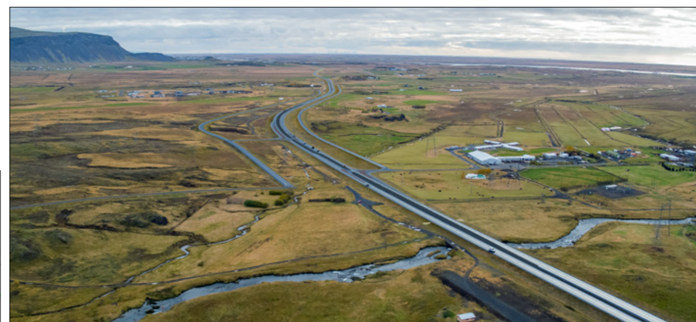
Tölvumynd Mannvit fyrir Vegagerðina. Vegarkafli Hringvegur (1) milli Hveragerðis og Selfoss sem nú er boðinn út. Efri myndin sýnir núverandi veg en neðri myndin sýnir nýja vegi. Það sem ekki síst einkennir þessa framkvæmd er mikil vegagerð til hliðar við stofnveginn sem þjónar umferð innan svæðis og fækkar vegamótum. Reynt er að bæta umferðaröryggi eins og mögulegt er, jafnhliða greiðri umferð í gegnum svæðið.
