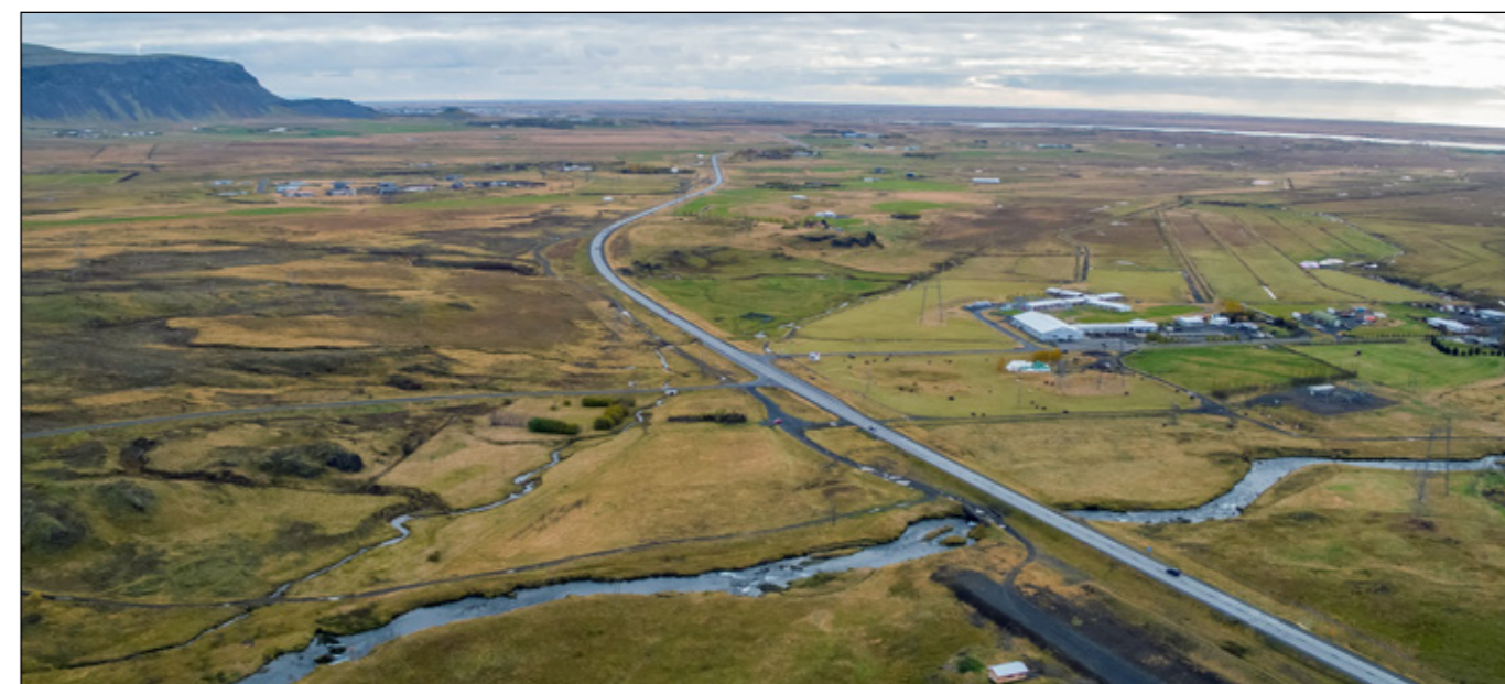
Tölvumynd Mannvit fyrir Vegagerðina. Breikkun Hringvegur (1) byrjar hjá Kambarótum og sveigir svo frá núverandi Suðurlandsvegi. Vegamót Þorlákshafnarvegur (38) færast um rúmlega 100 m til suðurs. Þessi kaflar er fyrri norðan kaflan sem nú er boðinn út.
