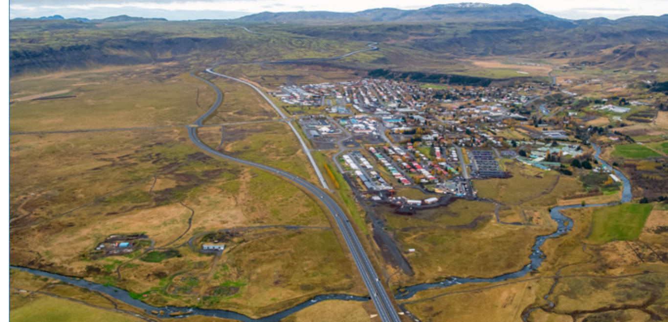
Tölvumynd Mannvit fyrir Vegagerðina. Breikkun Hringvegur (1) byrjar hjá Kambarótum og sveigir svo frá núverandi Suðurlandsvegi. Vegamót Þorlákshafnarvegur (38) færast um rúmlega 100 m til suðurs. Þessi kaflar er fyrri norðan kaflan sem nú er boðinn út.
