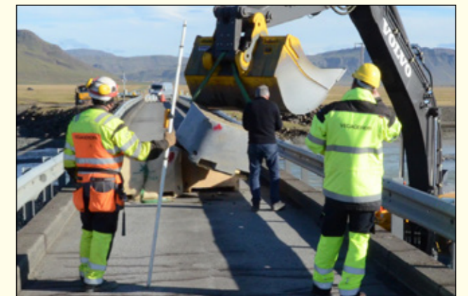
Gert var álagspróf á löskuðu brúnni. Það fór þannig fram að settur var þungi upp á 4 tonn á löskuðu höfin, þ.e. á milli ónýta stöplunsins og næstu stöpla til hvorrar hliðar. Fyrst var fargið sett á vestan megin og varð þá 3 mm sig en þegar álagið var tekið af rétti brúin sig af á ný. Það var því innan marka og mælingar á sprungum sýndu engar breytingar. Þá var farið í hafid austan megin og gert það sama. Svipað sig mældist þar en þegar álagið var tekið af fór brúin ekki aftur til baka, þ.e. sigið var orðið varanlegt. Þá voru mælingar endurteknaðar og álagið látið sitja í klukkustund. Austan megin jókst sigið enn frekar, var orðið 7 mm og fór ekki til baka. Greinilegt var að burðarkerfi brúarinnar var orðið alveg ónýtt og flot varanlegt. Því var ákveðið að hleypa ekki umferð léttra bíla á brúna.
