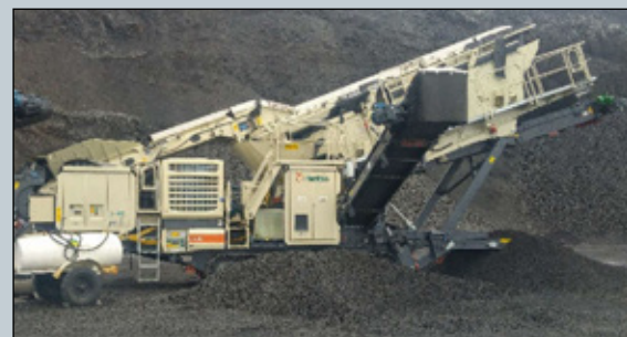
Efnið var fyrst forbrotið í kjaftbrjót Metso LT 120 en fór síðan í kónbrjót Metso LT 330.
