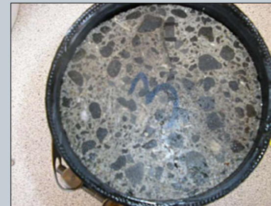
Sprungið steypusýni í hulsu.
