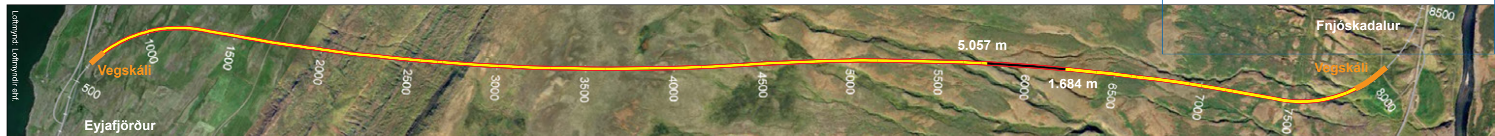
Vaðlaheiðargöng, staða framkvæmda 13. febrúar 2017. Búið er að sprengja samtals 6.741 m sem er 93,5% af heildarlengd.
