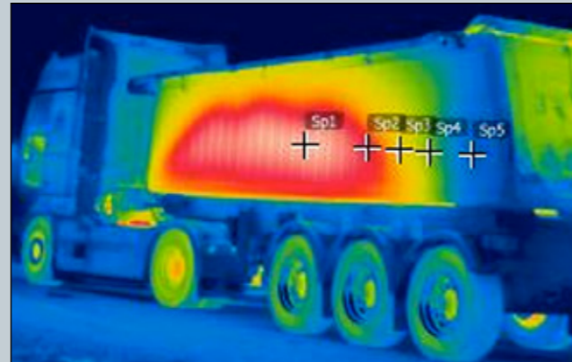
Hitastig á palli flutningabíls. Hitamynd.
