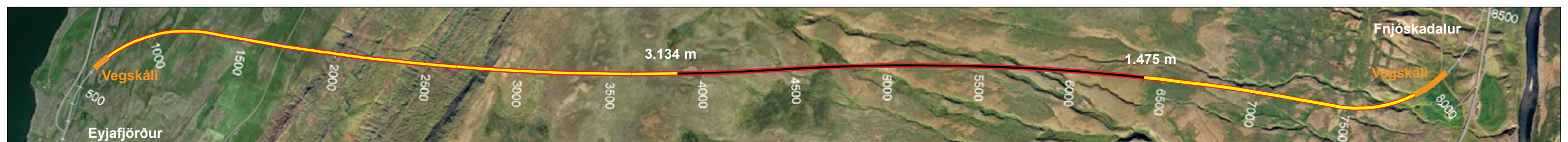
Vaðlaheiðargöng, staða framkvæmda 14. desember 2015. Búið er að sprengja samtals 4.609 m sem er 64% af heildarlengd.
