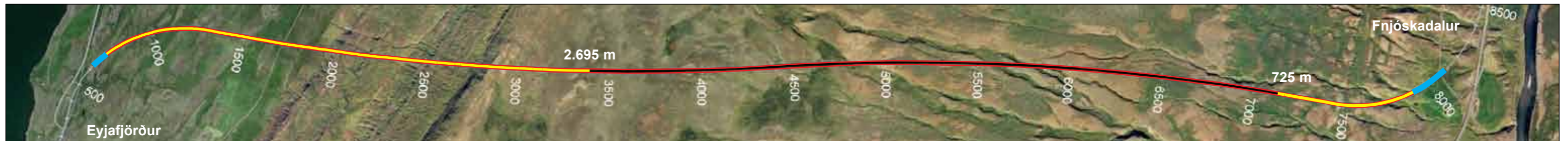
Vaðlaheiðargöng, staða framkvæmda fyrir jólafrí 22. desember 2014. Búið er að sprengja samtals 3.420 m sem er 47,5% af heildarlengd.
