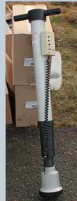
SOBO 20. Tveir mælur af þessari gerð eru í notkun hjá vaktstöð Vegagerðarinnar í Hafnarfirði. Mælirinn gefur stalmagn í vegi í grömmum á fermetra. Mælarnir eru fljótlegir í notkun og auðvelt að taka þá með í eftirlitsbíl og ná þannig inn upplýsingum um rest-salt í vegi á þeirri leið sem ekin er.
