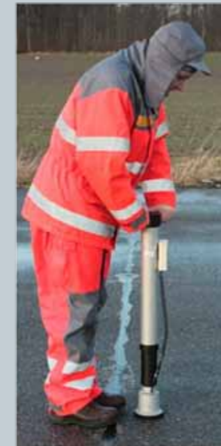
SOBO 20. Tveir mælur af þessari gerð eru í notkun hjá vaktstöð Vegagerðarinnar í Hafnarfirði. Mælirinn gefur stalmagn í vegi í grömmum á fermetra. Mælarnir eru fljótlegir í notkun og auðvelt að taka þá með í eftirlitsbíl og ná þannig inn upplýsingum um rest-salt í vegi á þeirri leið sem ekin er.
