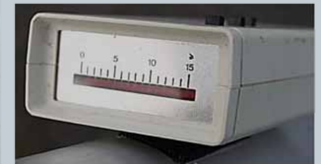
SOBO 20. Tveir mælur af þessari gerð eru í notkun hjá vaktstöð Vegagerðarinnar í Hafnarfirði. Mælirinn gefur stalmagn í vegi í grömmum á fermetra. Mælarnir eru fljótlegir í notkun og auðvelt að taka þá með í eftirlitsbíl og ná þannig inn upplýsingum um rest-salt í vegi á þeirri leið sem ekin er.
