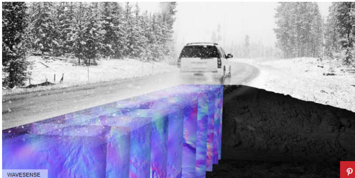
Mynd 2) Greining yfirborðs vega með jarðsjá.
