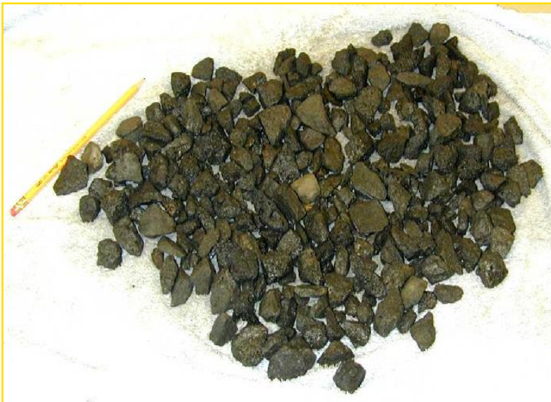
Mynd 25 Vatnsmettað og yfirborðsþerrað sýni
