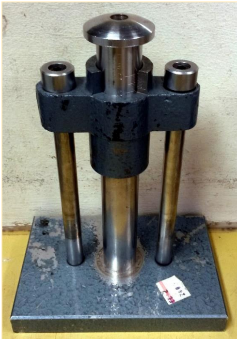
Mynd 14 a) og b) Búnaður til að mæla Rigden holrýmd mélu
