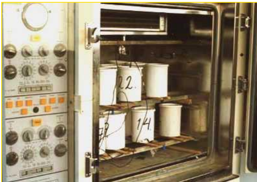
Mynd 45 Frost/þíðu skápur með sýnadósum
