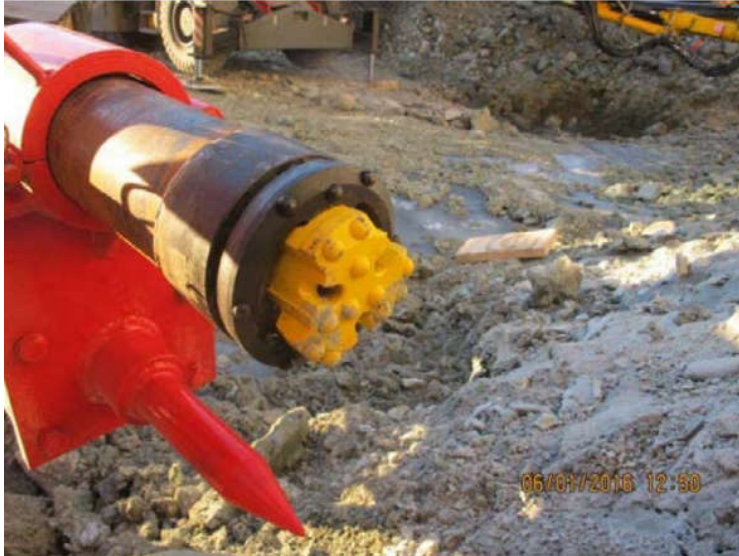
Mynd 21. Endi rörs/fóðringar, með skó og borkrónu (gul) sem hægt er að draga til baka [11].
