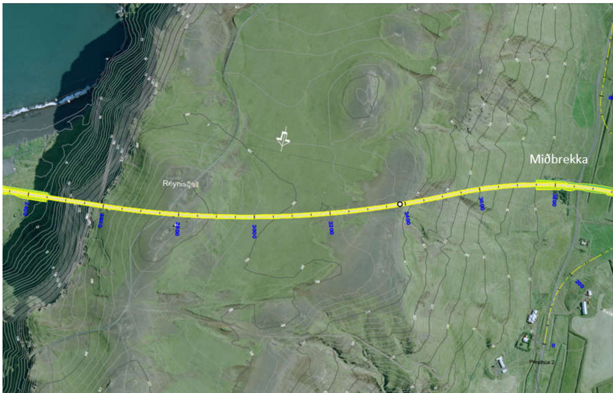
Mynd 1. Lega ganga undir Reynisfjall – planmynd (Hnit).
