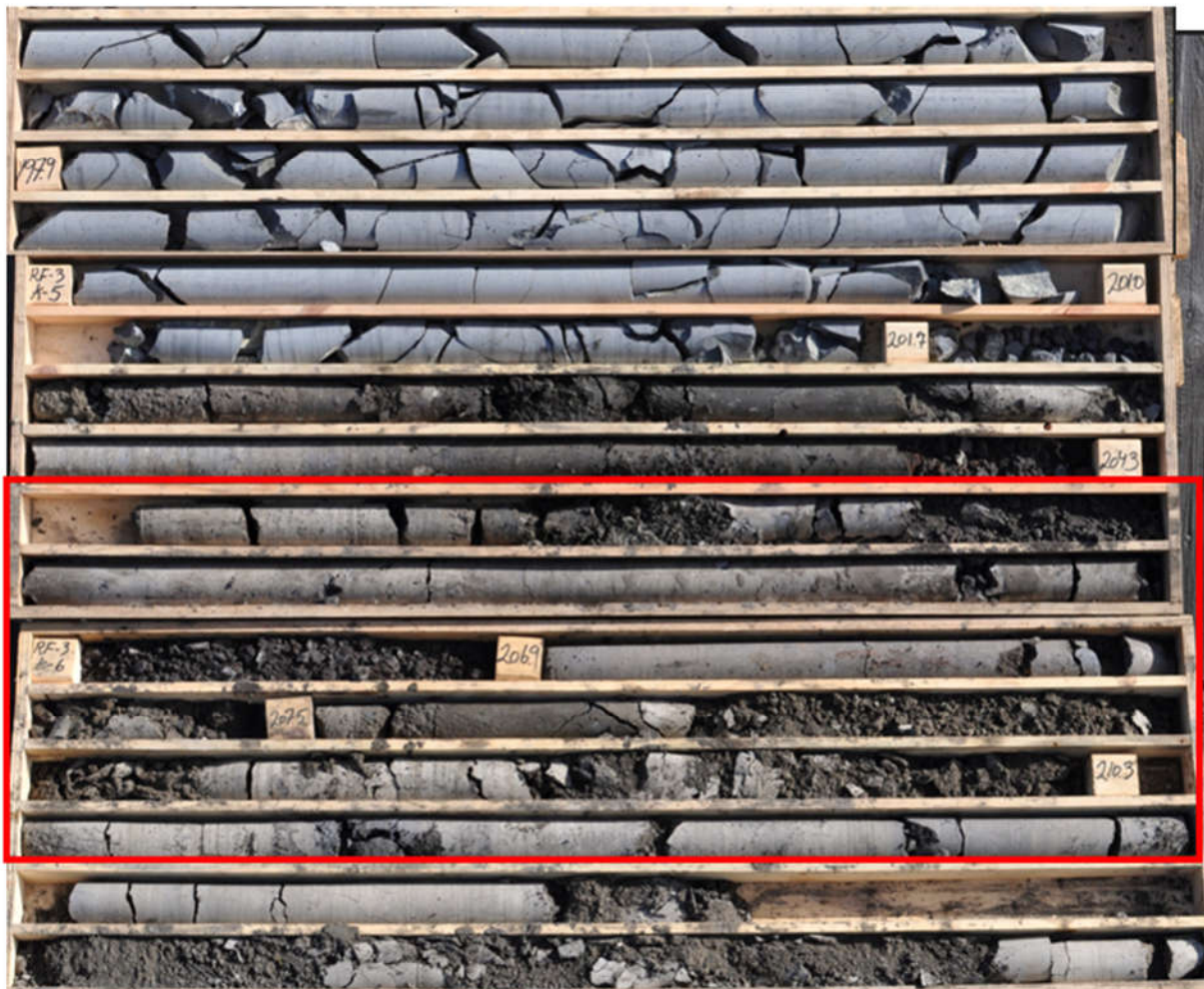
Mynd 8. Borkjarni RF-3, áætlað gangadýpi frá ca. 194-202 m dýpi.
