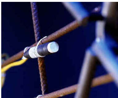
Mynd 19. Uppsetning á viðmiðunarelektróðu ERE 20 - MnO 2 – elektróður.
