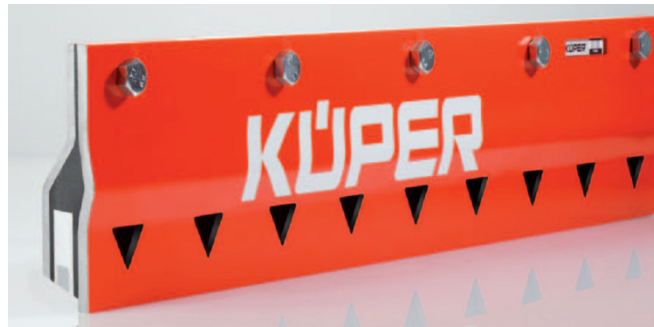
Mynd 1. Samsett slitblað sem er lagskipt úr stáli, gúmmí og keramik. Þessi gerð hefur komið vel út hvað varðar endingu, hreinsunar eiginleika og hávaðastig.
