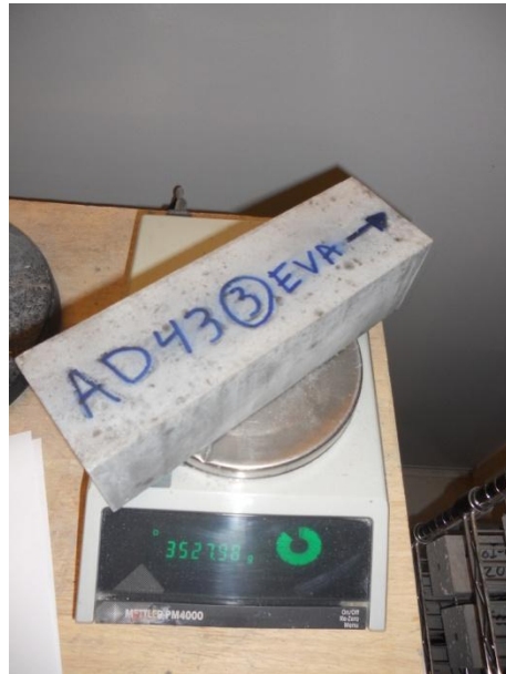
Mynd 22: Mæling á þyngdarbreytingu, mynd ELÁ
