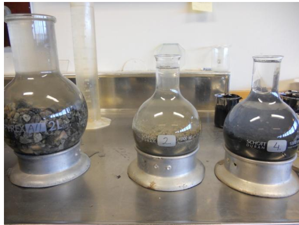
Mynd 8: Rannsókn á kornarúmpýngd, mynd ELÁ
