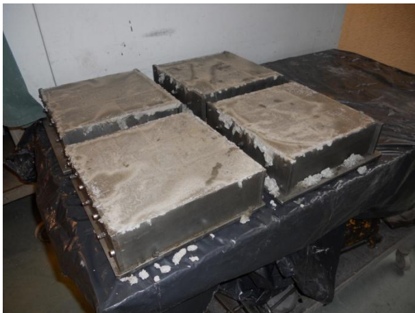
Mynd 19: Steypt í rýrnunarmót, mynd ELÁ
