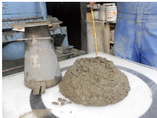
Mynd 16: Sigmálsmæling á verkstað, mynd ELÁ
