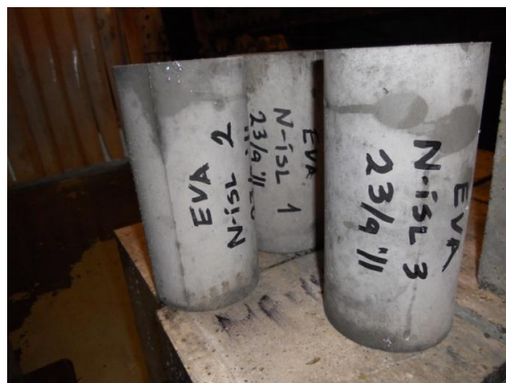
Mynd 18: Steyptir sívalningar til þrýstipolsprófunar, mynd ELÁ
