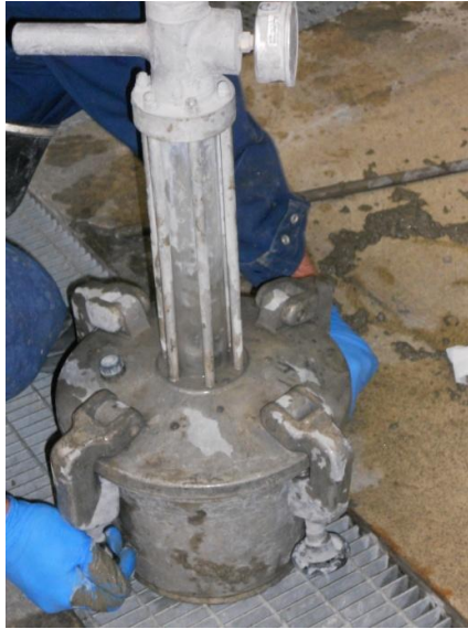
Mynd 17: Loft- og rúmmálmæling á verkstað, mynd ELÁ
