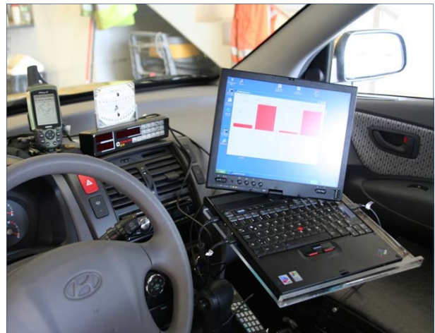
Mynd 5 Mæliforrit, Profile Recorder frá Greenwood Engineering og tölvu í Hyundai bíl á&e-deildar, sem notaður var við mælingar 2006 og 2007
