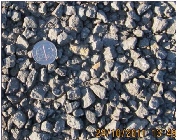
Mynd 25 Suðurstrandarvegur (427) nýbygging sem lokið við haustið 2011. Verktaki Suðurverk ehf. IRI = 3,41 (3, 21) mm/m, gróft yfirborð og sem forvitnilegt verður að vita hvernig hryfið þróast.
