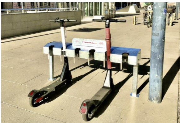
Mynd 5.3 Dönsk framleiðsla á skútustæðum, hér geta 6 rafskútur verið lagðar samtímis, hægt er að læsa rafskútunum með hengilási (Scooter Rack 123, n.d.)
