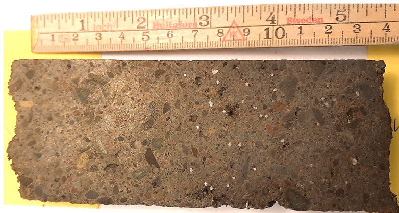
Mynd 13: Kjarnasýni fyrir þunnsneiðargerð. Yfirborð sprautusteypu er vinstra megin. Tvö lög af sprautusteypu, það neðra er með trefjum en yfirlagið er trefjalaust.
