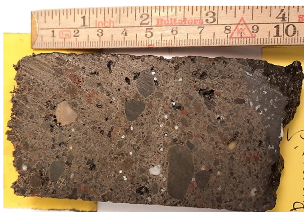
Mynd 17: Kjarnasýni fyrir þunnsneiðargerð. Yfirborð sprautusteypu er vinstra megin og hægra megin má sjá undirliggjandi berg (basalt) uppi í hægra horninu. Tvö lög af sprautusteypu, það neðra er með stáltrefjum en yfirlagið er að mestu trefjalaust (vottar fyrir mikkrotrefjum).
