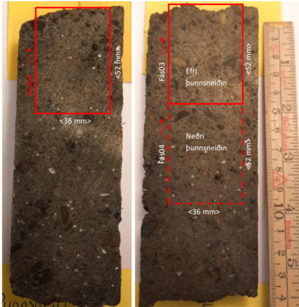
Mynd 5: Skýringarmynd af því hvar þunnsneiðarnar voru teknar úr sýnunum. Til vinstri er sýnt hvar þunnsneiðin var tekin þar sem er ein þunnsneið í sýni. Til hægri sýnt hvar þunnsneiðar voru teknar þar sem gerðar voru tvær þunnsneiðar úr sama sýninu.
