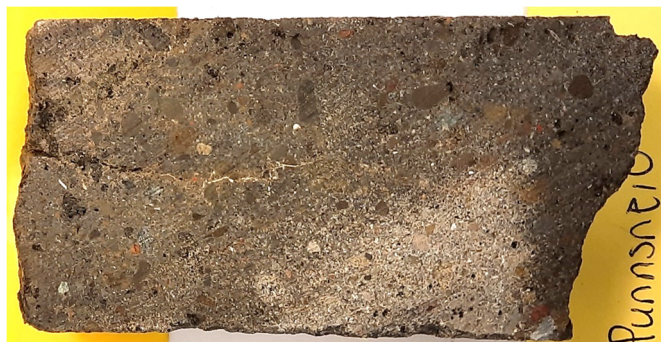
Mynd 8: Kjarnasýni fyrir þunnsneiðargerð. Yfirborð sprautusteypu er vinstra megin.
