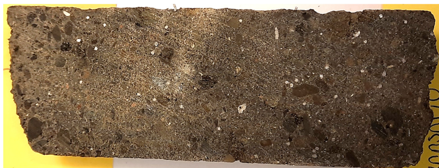
Mynd 9: Kjarnasýni fyrir þunnsneiðargerð. Yfirborð sprautusteypu er vinstra megin.
