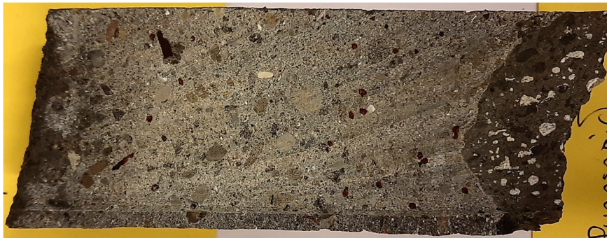
Mynd 6: Kjarnasýni fyrir þunnsneiðargerð. Yfirborð sprautusteypu er vinstra megin og hægra megin má sjá undirliggjandi berg (basalt).
