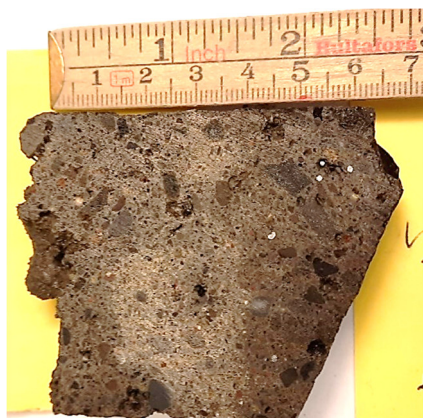
Mynd 14: Kjarnasýni fyrir þunnsneiðargerð. Yfirborð sprautusteypu er vinstra megin.
