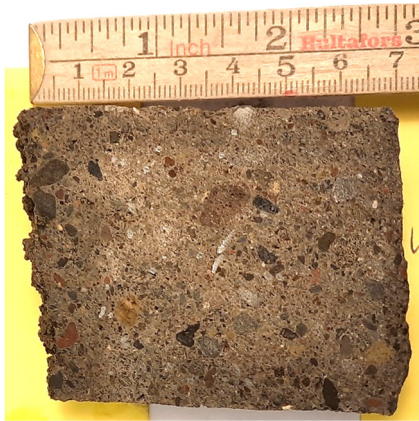
Mynd 15: Kjarnasýni fyrir þunnsneiðargerð. Yfirborð sprautusteypu er vinstra megin.
