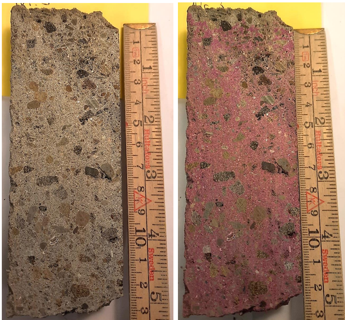
Mynd 4: Dæmi um vinnslu sýna fyrir mælingu á kolsýringu á sýni úr stöð 4898 í Hvalfjarðargöngum, sýni nr.3. Til vinstri er búið að saga kjarnasýnið eftir endilöngu og til hægri þá er búið að úða lausn á sýnið, ólitaða yfirborðið er kolsýrt (næst yfirborði sprautusteypunnar).
