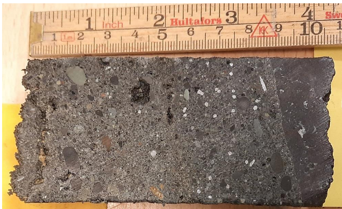
Mynd 11: Kjarnasýni fyrir þunnsneiðargerð. Yfirborð sprautusteypu er vinstra megin og hægra megin má sjá undirliggjandi berg (basalt). Þrjú lög af sprautusteypu, neðst er steypa með trefjum, millilagið er án trefja og yfirlagið er u.þ.b. 10 mm þykk skúmsteypa.
