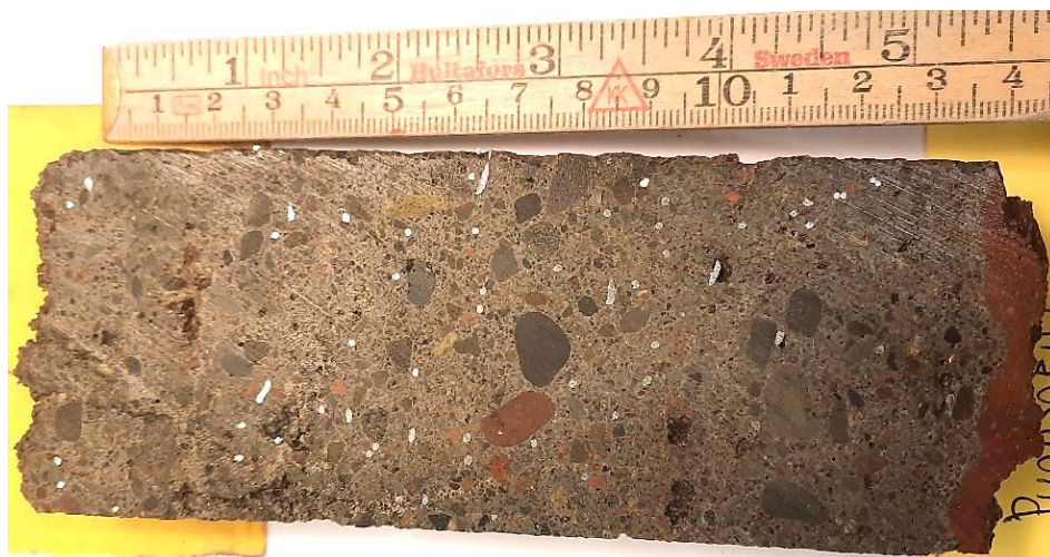
Mynd 25: Kjarnasýni fyrir þunnsneiðargerð. Yfirborð sprautusteypu er vinstra megin og hægra megin má sjá undirliggjandi berg (kargi).
