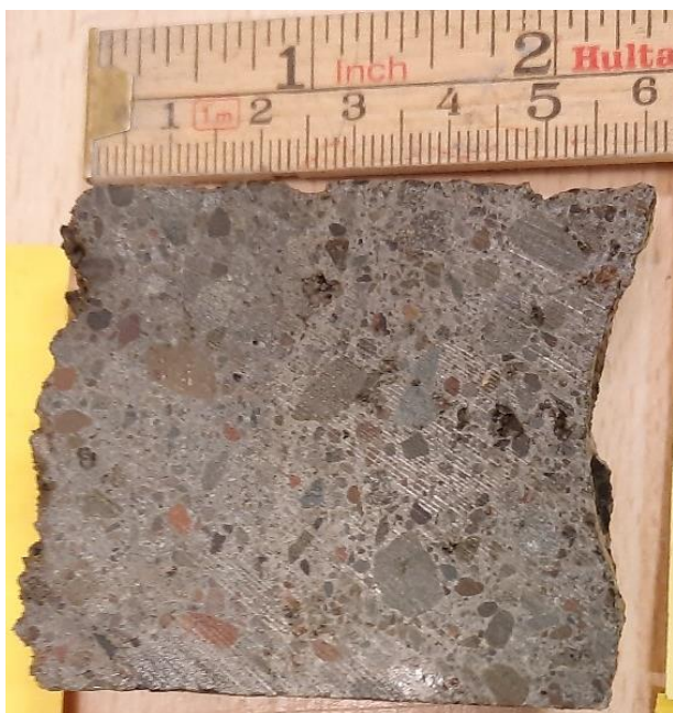
Mynd 22: Kjarnasýni fyrir þunnsneiðargerð. Yfirborð sprautusteypu er vinstra megin. Tvö lög af sprautusteypu án trefja.
