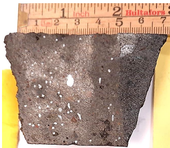
Mynd 43: Kjarnasýni fyrir þunnsneiðargerð. Yfirborð sprautusteypu er vinstra megin og hægra megin má sjá undirliggjandi berg (basalt). Tvö lög af sprautusteypu með trefjum.
