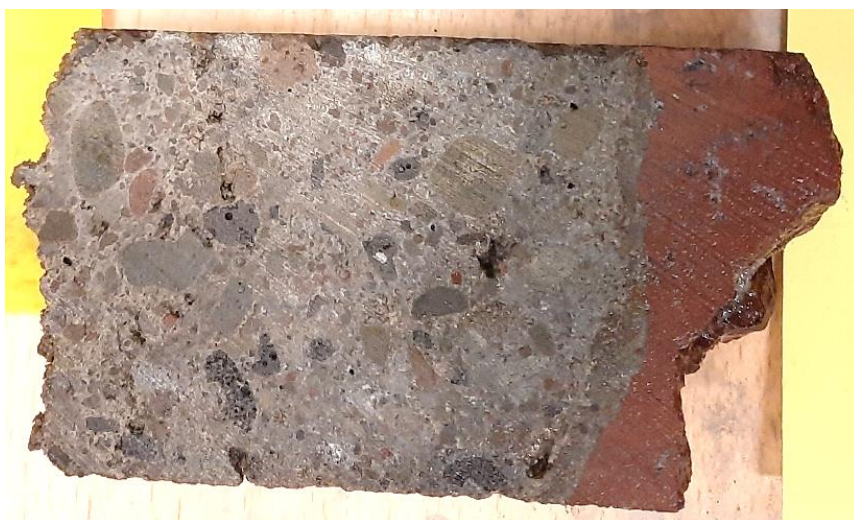
Mynd 23: Kjarnasýni fyrir þunnsneiðargerð. Yfirborð sprautusteypu er vinstra megin og hægra megin má sjá undirliggjandi berg (setberg). Líklega eitt lag af sprautusteypu án trefja.
