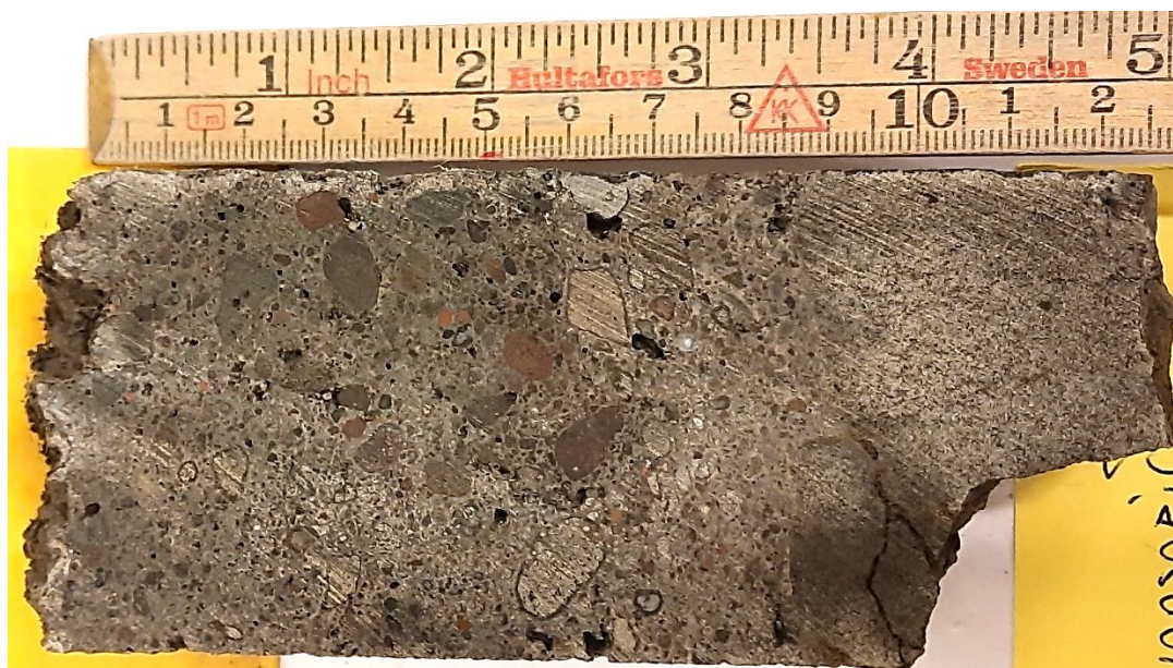
Mynd 33: Kjarnasýni fyrir þunnsneiðargerð. Yfirborð sprautusteypu er vinstra megin og hægra megin má sjá undirliggjandi berg (basalt).
