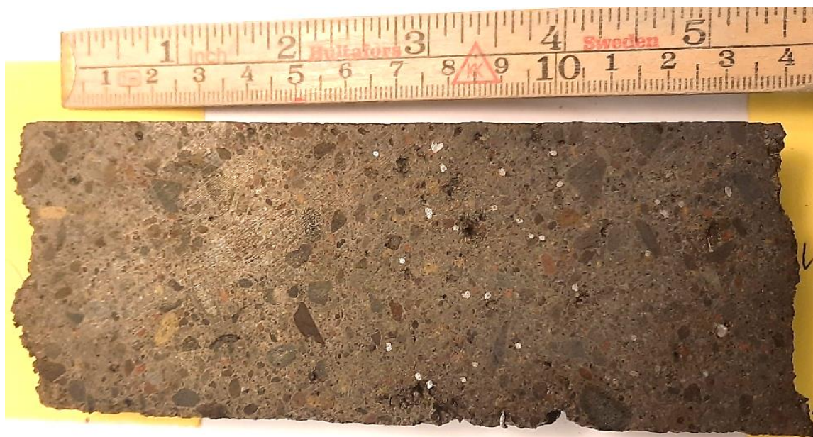
Mynd 26: Kjarnasýni fyrir þunnssneiðargerð. Yfirborð sprautusteypu er vinstra megin. Tvö lög af sprautusteypu, það neðra er með trefjum en yfirlagið er trefjalaust.
