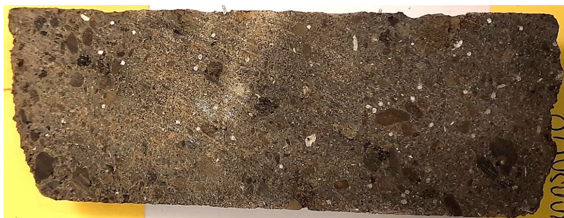
Mynd 37: Kjarnasýni fyrir þunnsneiðargerð. Yfirborð sprautusteypu er vinstra megin.
