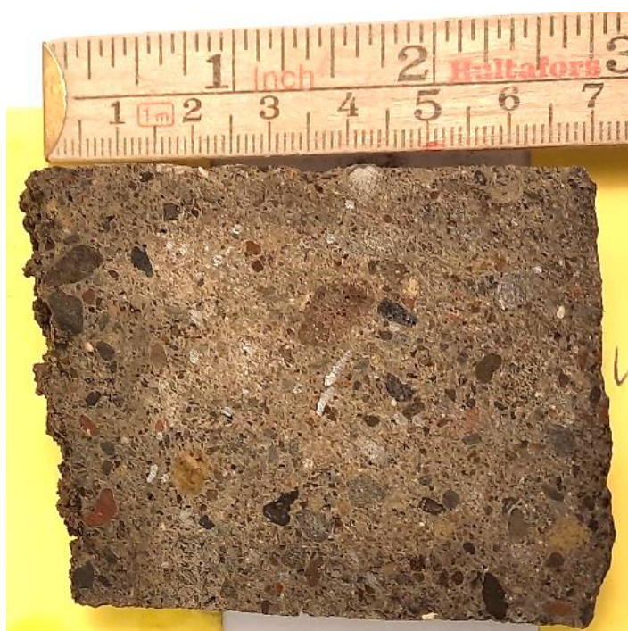
Mynd 28: Kjarnasýni fyrir þunnsneiðargerð. Yfirborð sprautusteypu er vinstra megin.
