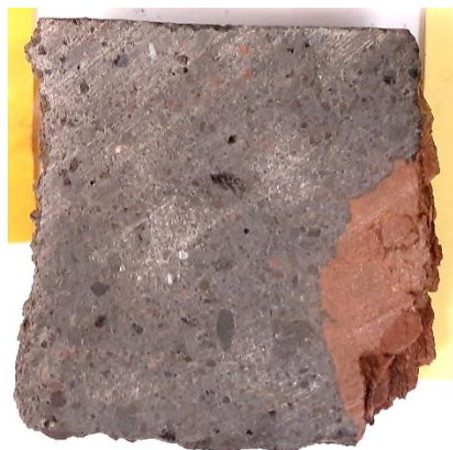
Mynd 44: Kjarnasýni fyrir þunnsneiðargerð. Yfirborð sprautusteypu er vinstra megin og hægra megin má sjá undirliggjandi berg (setberg). Eitt lag af sprautusteypu án trefja.
