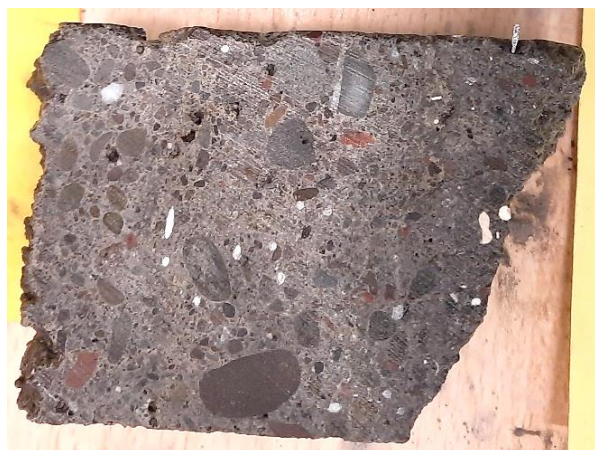
Mynd 14: Kjarnasýni fyrir þunnssneiðargerð. Yfirborð sprautusteypu er vinstra megin. Þrjú lög af sprautusteypu, neðri tvö eru með trefjum en yfirlagið er trefjalaust.
