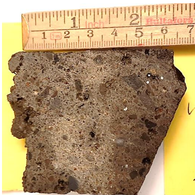
Mynd 27: Kjarnasýni fyrir þunnsneiðargerð. Yfirborð sprautusteypu er vinstra megin.
