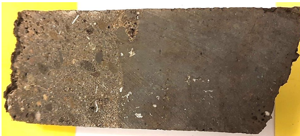
Mynd 35: Kjarnasýni fyrir þunnsneiðargerð. Yfirborð sprautusteypu er vinstra megin og hægra megin má sjá undirliggjandi berg (basalt).
