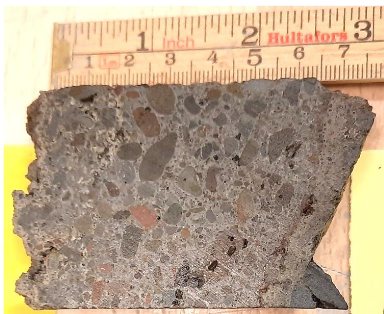
Mynd 18: Kjarnasýni fyrir þunnsneiðargerð. Yfirborð sprautusteypu er vinstra megin og hægra megin má sjá brot af undirliggjandi bergi (basalt). Tvö til þrjú lög af sprautusteypu án trefja.
