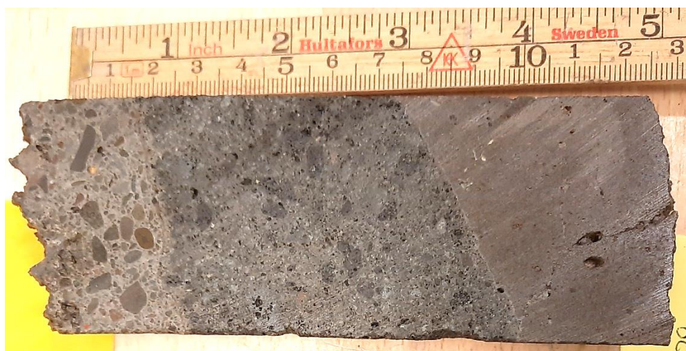
Mynd 19: Kjarnasýni fyrir þunnssneiðargerð. Yfirborð sprautusteypu er vinstra megin og hægra megin má sjá undirliggjandi berg (basalt). Tvö lög af sprautusteypu án trefja.
