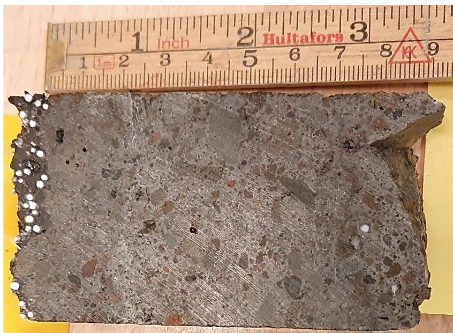
Mynd 20: Kjarnasýni fyrir þunnssneiðargerð. Yfirborð sprautusteypu er vinstra. Líklega þrjú lög af sprautusteypu, neðri tvö eru án trefja og yfirlagið er skúmsteypa með plastkúlum.
