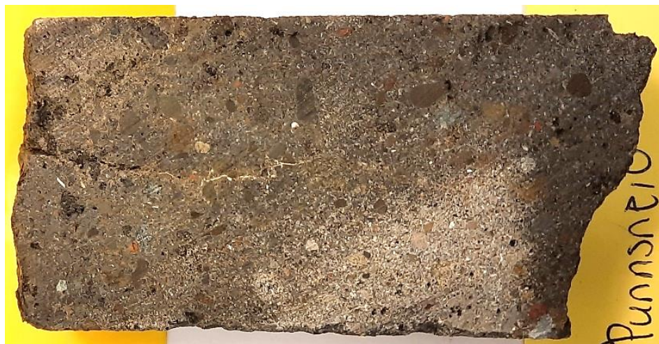
Mynd 36: Kjarnasýni fyrir þunnsneiðargerð. Yfirborð sprautusteypu er vinstra megin.
