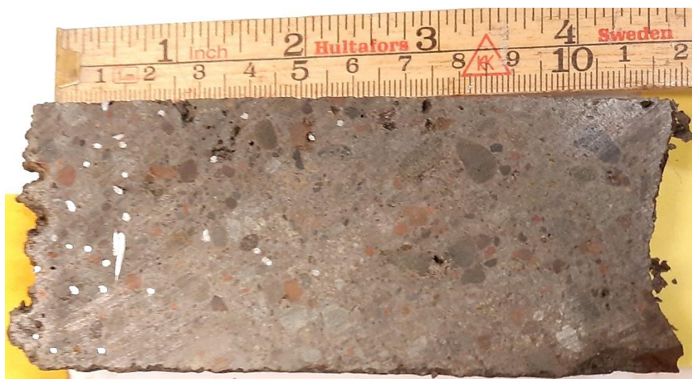
Mynd 41: Kjarnasýni fyrir þunnsneiðargerð. Yfirborð sprautusteypu er vinstra megin. Líklega eitt lag af sprautusteypu, þar sem neðri hlutinn er án trefja, en trefjar næst yfirborði.
