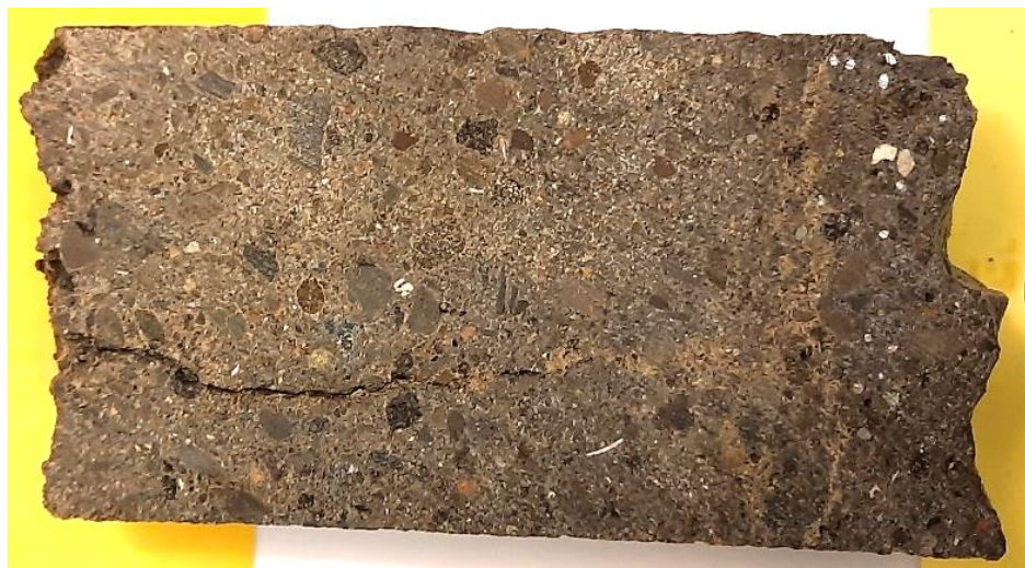
Mynd 38: Kjarnasýni fyrir þunnsneiðargerð. Yfirborð sprautusteypu er vinstra megin. Nálægt hægri enda má sjá skil á milli sprautusteypulaga.
