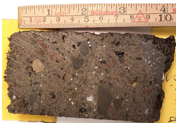
Mynd 30: Kjarnasýni fyrir þunnsneiðargerð. Yfirborð sprautusteypu er vinstra megin og hægra megin má sjá undirliggjandi berg (basalt) uppi í hægra horninu. Tvö lög af sprautusteypu, það neðra er með stáltrefjum en yfirlagið er að mestu trefjalaust (vottar fyrir míkrótrefjum).
