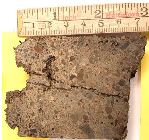
Mynd 29: Kjarnasýni fyrir þunnsneiðargerð. Yfirborð sprautusteypu er vinstra megin.
