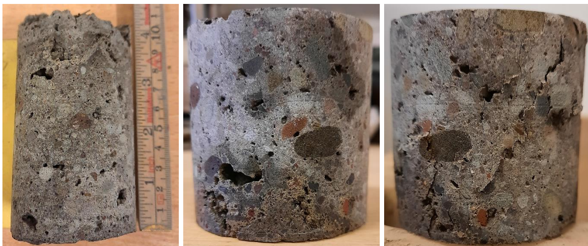
Mynd 3: Dæmi um vinnslu sýna fyrir prófun á einásabrotstyrk á sýni í stöð 4336 í Héðinsfjarðargöngum, sýni nr.1. Til vinstri er óunnið kjarnasýni, í miðjunni er búið að saga það í l/b=1 og slípa endana og til hægri er sýnið eftir brot.
