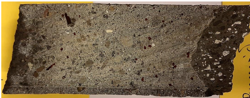
Mynd 34: Kjarnasýni fyrir þunnsneiðargerð. Yfirborð sprautusteypu er vinstra megin og hægra megin má sjá undirliggjandi berg (basalt).
