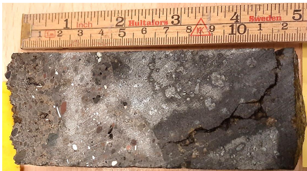
Mynd 13: Kjarnasýni fyrir þunnssneiðargerð. Yfirborð sprautusteypu er vinstra megin og hægra megin má sjá undirliggjandi berg (basalt). Tvö lög af sprautusteypu, það neðra er með trefjum en yfirlagið er trefjalaust.
