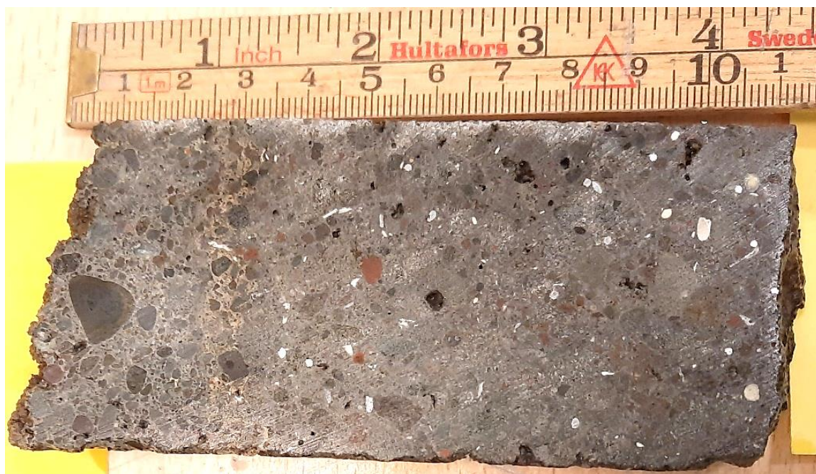
Mynd 17: Kjarnasýni fyrir þunnsneiðargerð. Yfirborð sprautusteypu er vinstra megin. Tvö lög af sprautusteypu, það neðra er með trefjum en yfirlagið er trefjalaust.
