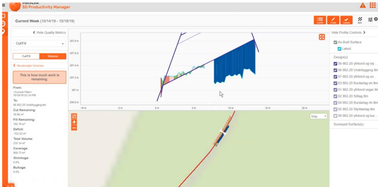
MYND 11 Dæmi úr VisionLink. Þegar síað er niður á hæð vegyfirborðs er hægt að fá fram magntöku, hér er slegið á hversu mikið á eftir að fylla til að ná upp að styrktarlagi.
