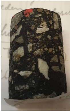
Mynd 7. Sýni H3-14. Kjarni sem er um 24 mm í þvermál og 36 mm á lengd.
