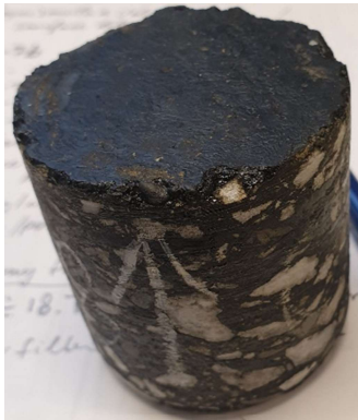
Mynd 5. Sýni C-1-8. Kjarni sem er 54 mm í þvermál og 54 mm á lengd.
