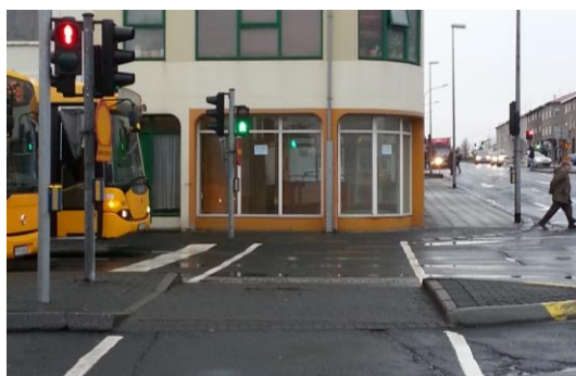
Mynd 22 Gönguþverun á umferðarljósa- stýrðum gatnamótum. Hér er hætta á að gangandi vegfarandi horfi á „rangt“ ljós og gangi á móti rauðu ljósi.
