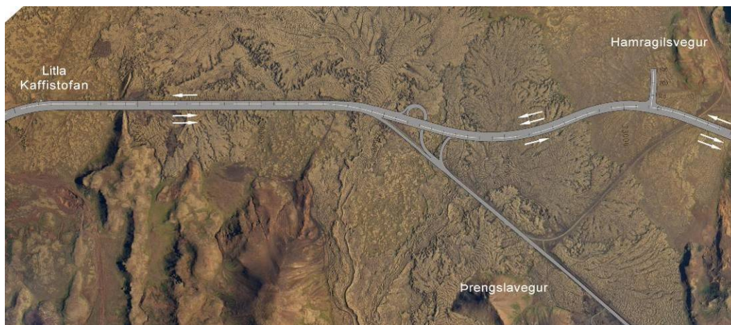
Mynd 3.1. 2+1 vegur á Suðurlandsvegi milli Litlu kaffistofunnar og Hveradalabrekku.
