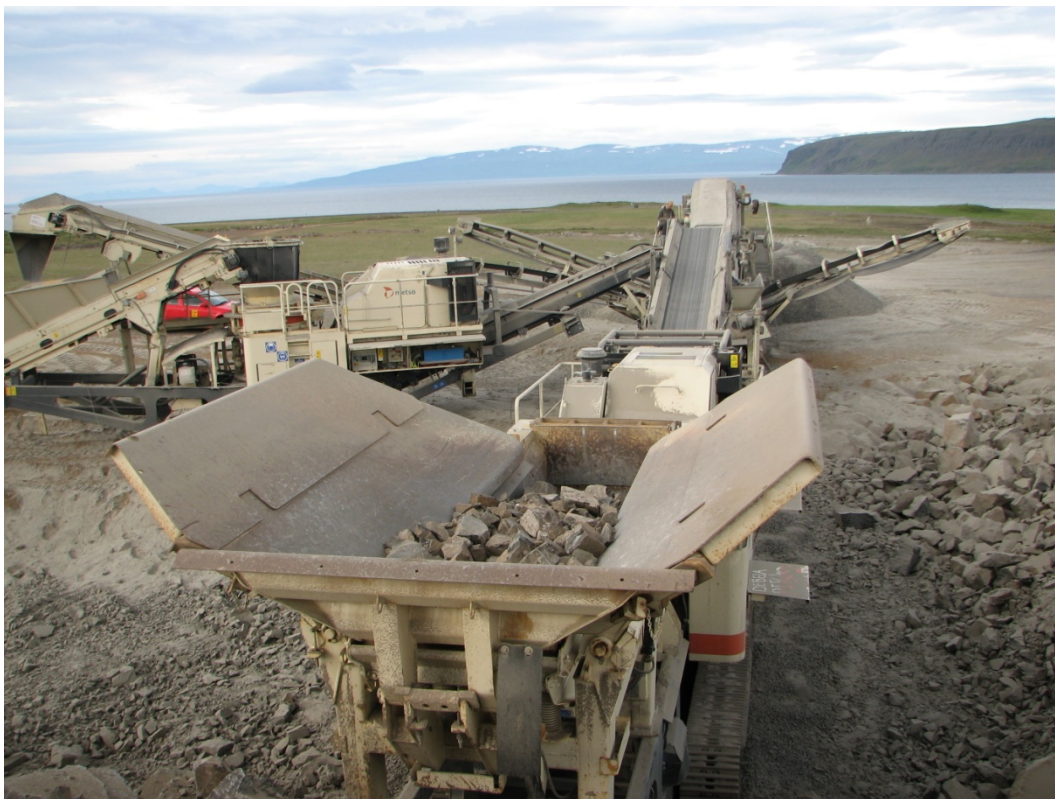
Mynd 4. Færanleg samstæða: kjaftrjótur, þriggja dekkja harpa og kóntrjótur. Öll tækin eru á beltum.
