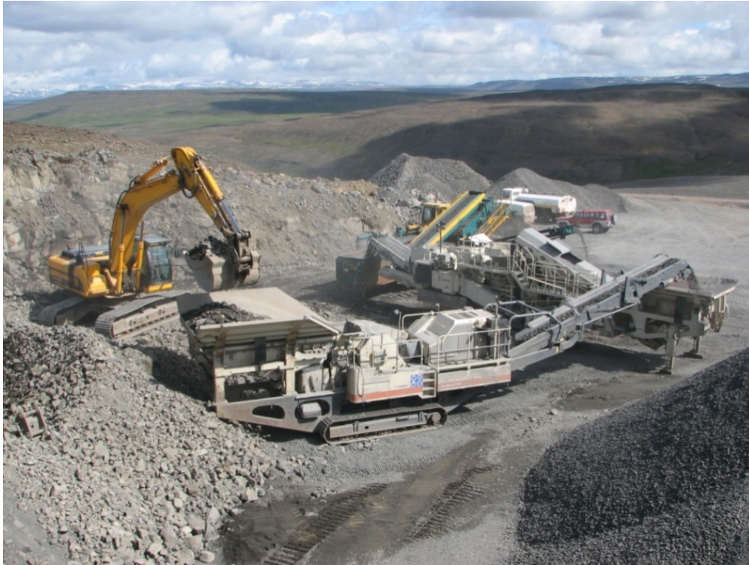
Mynd 2. Færanleg samstæða: kjaftbrjótur (forbrjótur) , kónbrjótur (eftirbrjótur) og tveggja dekkja harpa. Öll tækin eru á beltum.
