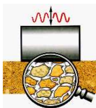
Mynd 28. Áhrif titringsþjöppunar á jarðefniskorn. 48
