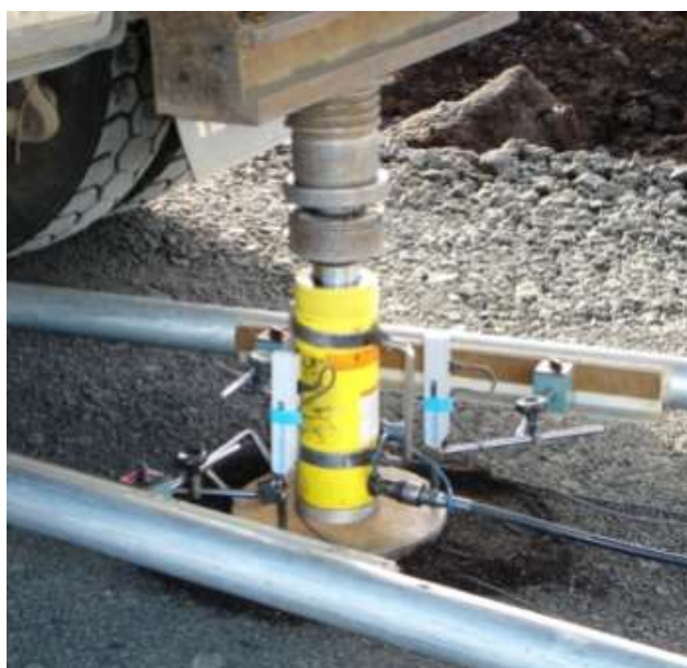
Mynd 36. Plötupróf í framkvæmd.
