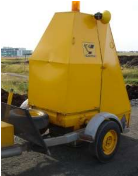
Mynd 41. Falllóðsprófi í framkvæmd og skematísk mynd af því hvernig það vinnur.
