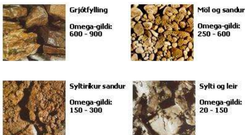
Mynd 55. Algeng þjöppunargildi (Omega) frá þjöppumæli í Bomag valtara.
