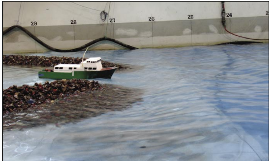
Mynd 3.2.1. Frá líkantilraunum í rannsóknarstöð Siglingastofnunar. Ferja siglir út úr mynni ferjuhafnarinnar á Bakkafjöru
