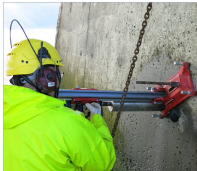
Rannsóknarverkefni, steypa í sjávarfallaumhverfi, kjarnaborun í Óseyrarbrú 2017.
