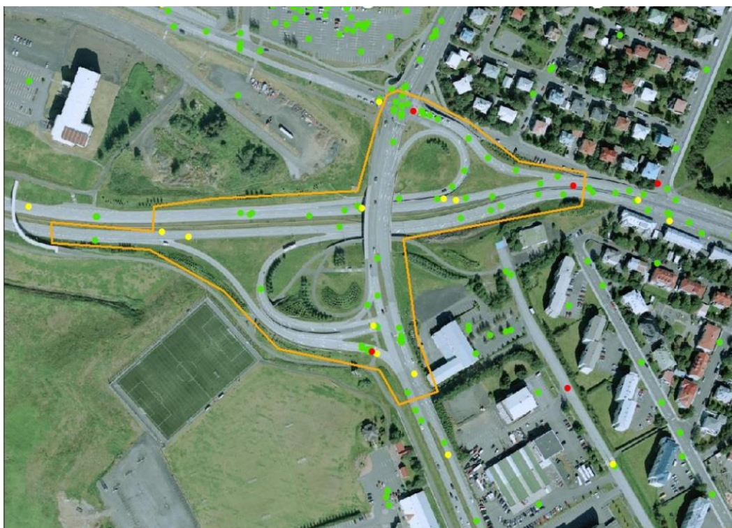
Mynd 3.1.1 Staðsetning slysa við gatnamót Snorrabrautar/Bústaðavegar og Miklubrautar/Hringbrautar. Svæðið sem heyrir undir gatnamótin er innan appelsínugulu línunnar. Slysa án meiðsla eru merkt grænum punkti, slysa með litlum meiðslum eru merkt gulum punkti, slysa með alvarlegum meiðslum eru merkt rauðum punkti.
