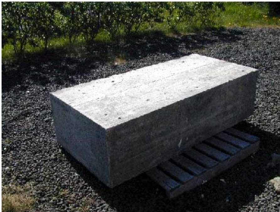
Mynd 3. Prufustykki. Stykkið er 500 mm á þykkt, 1820 mm á lengd og 880 mm á breidd.
