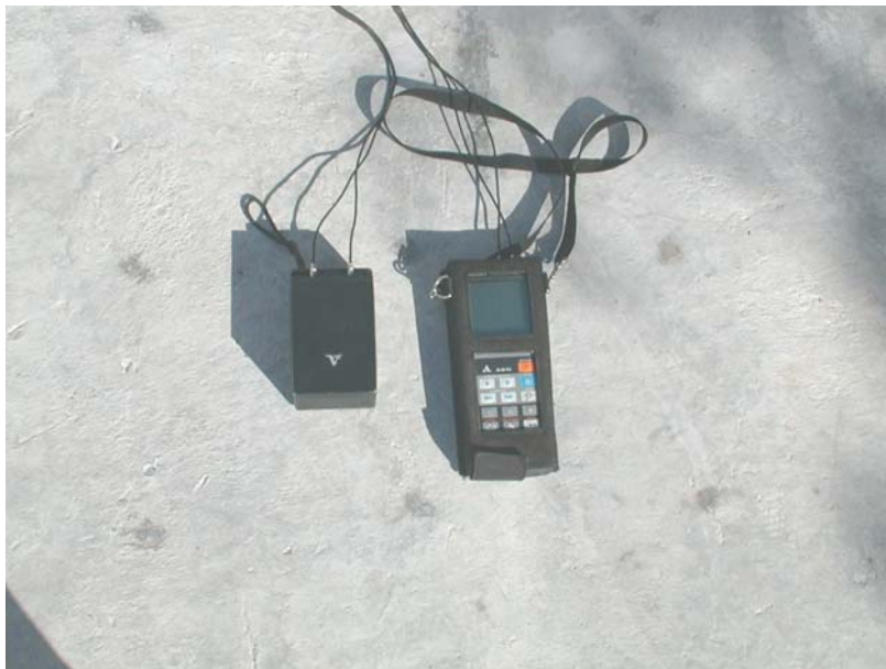
Mynd 1. Rússneska NDT-mælitækið (NDT-non destructive testing), sendarnir og nemarnir eru staðsettir í kassanum til vinstri (hann er 10x15 cm) og gagnasafnarinn er til hægri á myndinni.
