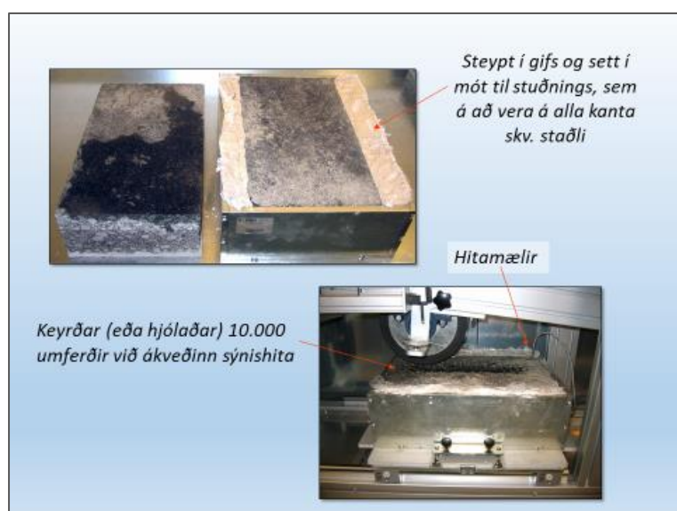
Mynd 2.2 Malbiksplötur og hjólið sem ekur á þeim með skýringum
