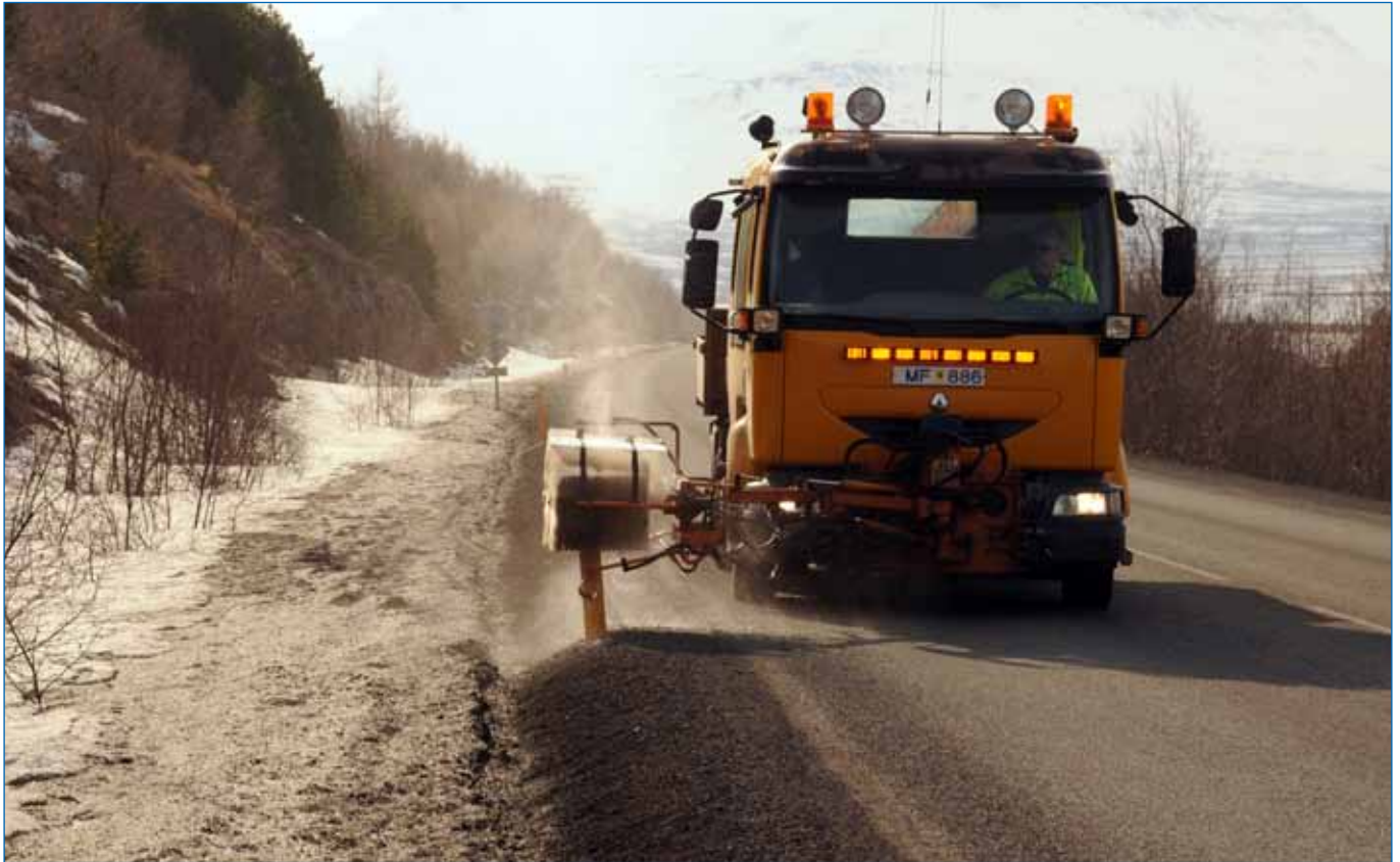
Um leið og snjórinn sjatnar fara starfsmenn þjónustustöðva Vegagerðarinnar af stað til að lagfæra eða þvo vegstikur. Myndin er tekin á Hringvegi (1) austan Akureyrar mánudaginn 31. mars og sýnir vélknúinn þvottakúst sem festur er á þjónustubífið.
