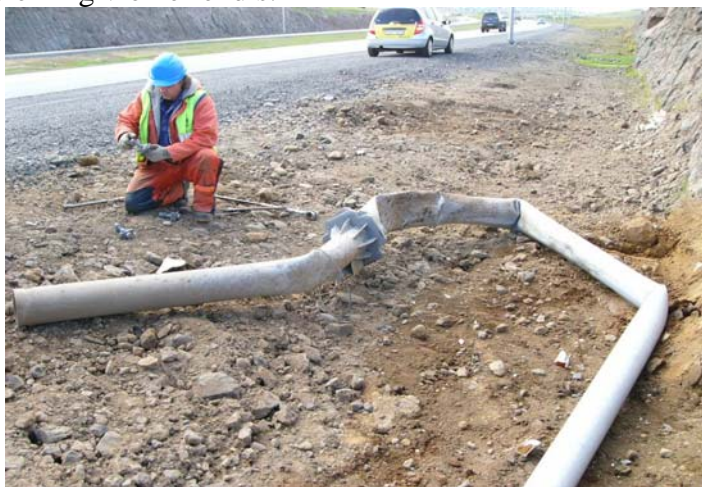
Mynd 16: Staur við Vesturlandsveg með skriðlið sem ekki gaf sig við árekstur.
